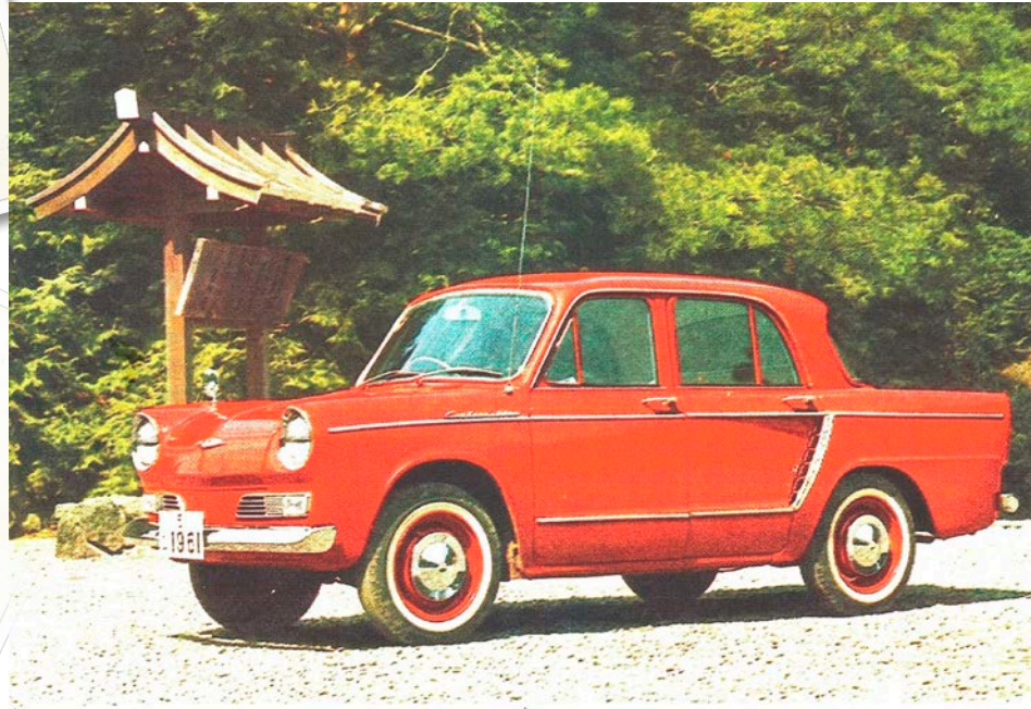
* La Contessa va bientôt être produite par la Hino Motor. La conception de la voiture s'apparente fortement à celle de la Dauphine. Avec 35 CV à 5 000 tr/mn, sa vitesse devrait atteindre 110 km/h. *
